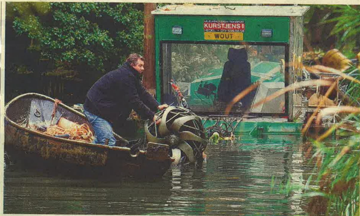
Eerst moet plastic uit de zuigermond worden verwijderd, dan kan het baggeren verdergaan. FOTO MARNIX SCHMIDT
